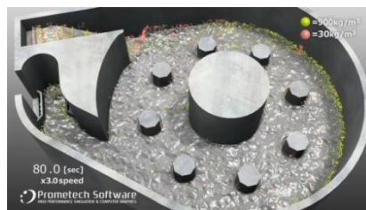
溶解炉内の金属屑流れ解析※1
