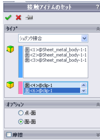
シュリンク接合で点-面、面- 面で比較
